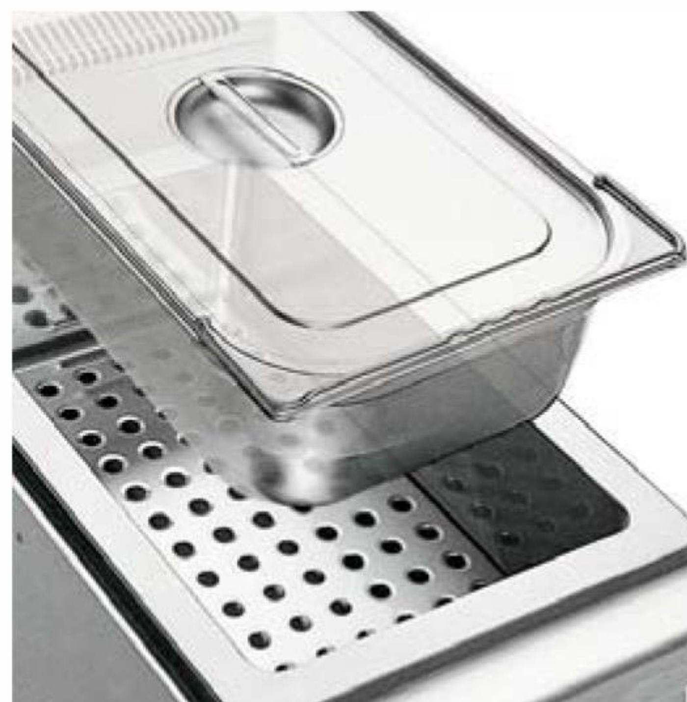
■ I bagnomaria elettrici hanno la vasca in acciaio inox stampata con angoli e bordi arrotondati e con la possibilità di inserire bacinelle GN fino ad un'altezza di 150 mm. La temperatura dell'acqua nella vasca può essere regolata da 30 a 90°C.
