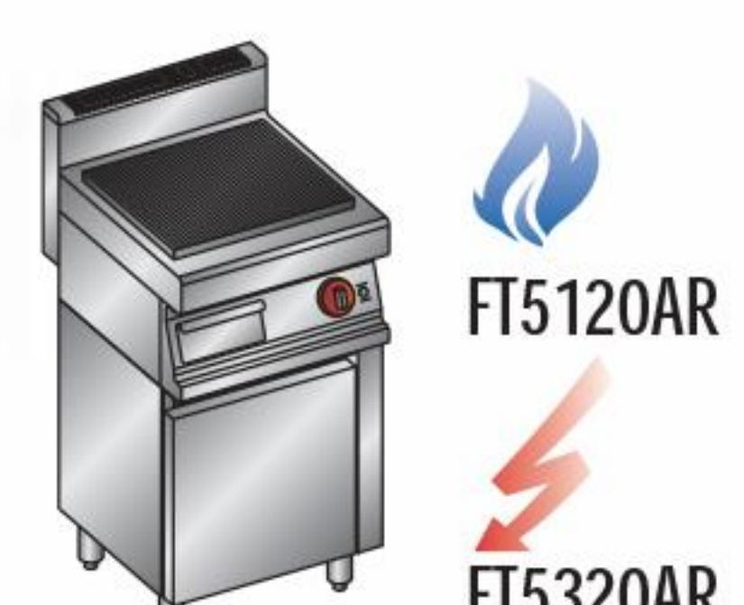
■ I fry-top a gas ed elettrici hanno una temperatura uniforme su tutta la superficie della piastra di cottura. Nei modelli da 1 modulo è possibile riscaldare la mezza piastra. I fry-top a gas hanno una valvola termostatica che permette la regolazione della temperatura da 100 a 340°C mentre per quelli elettrici la temperatura è controllata da un termostato di lavoro e da un termostato di sicurezza. Tutti i modelli hanno un ampio invaso e un cassetto sottostante per la raccolta dei liquidi.
